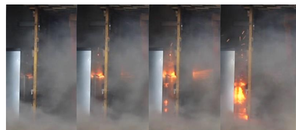
Typprüfung der 20-kV-Schaltanlage in einer Transformatorstation
